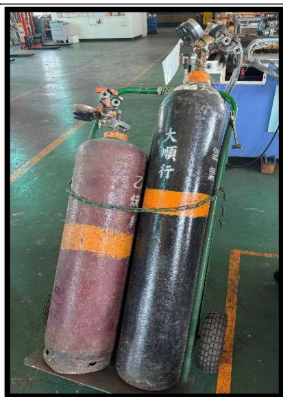
氧乙炔氣焊照片
